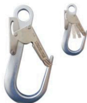
3805D aluminium Spécial échafaudage à verrouillage automatique ouverture 60mm 240 x 1 30mm, 430 gr. Résistance 22kN (2243kg)
